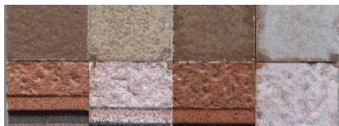
400hrs暴露 塗装前 未塗装 800hrs暴露後 無機ハイブリッドチタンガードクリア 800hrs暴露後 溶剤系クリア 800hrs暴露後
